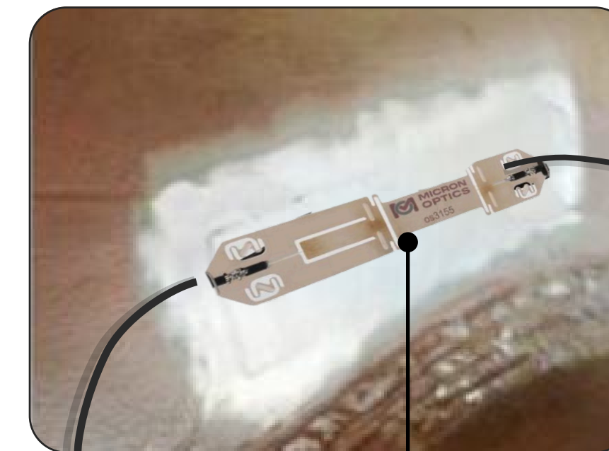
Оптоволоконные датчики (покупные)
