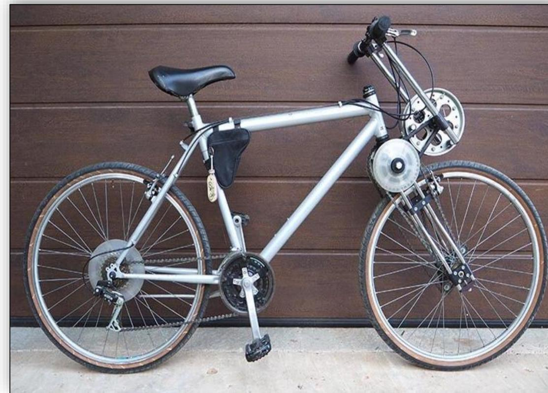
Итальянский полноприводный велосипед 2X2 Euromet 2WD, передний привод выполнен в виде рулевого кронштейна, вращающий момент на переднее колесо передается с помощью силы рук.
