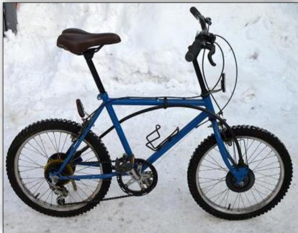
Полноприводной велосипед BWA Stinger 2WD, передний привод выполнен через гибкий вал.
