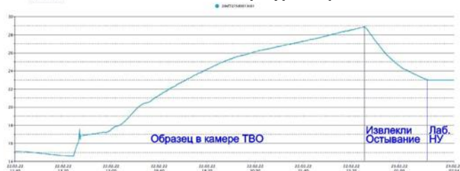
Термограмма датчика в образце. Показаны этапы температурного режима
